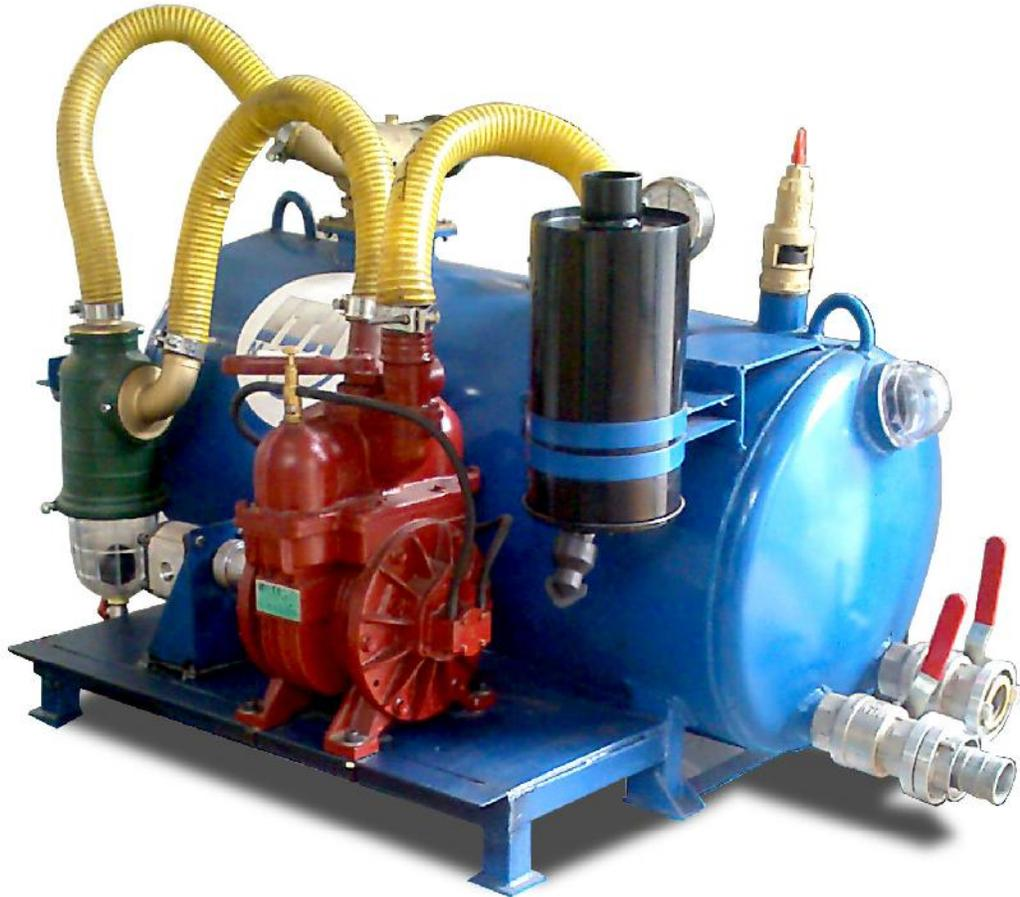
Diseño, Fabricación y montaje de equipos de absorción de líquidos residuales y sanitarios de casetas de uso faenero o pozos sépticos domiciliarios. Almacena fluidos y evita emanación de gases dada su configuración de sellado.
