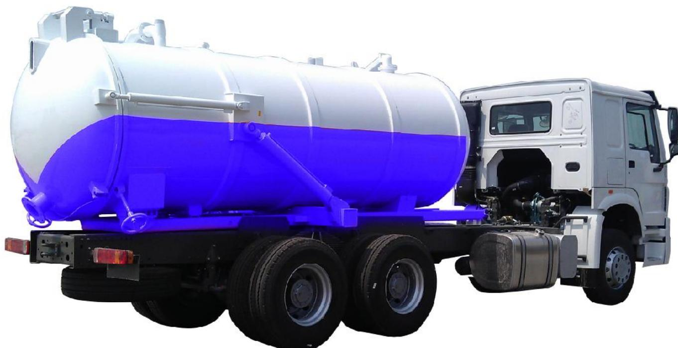
Estanque con fondo toriesférico de pulgada, cuenta con dos entradas hombre y dos rompeolas reforzados. Bandejas laterales con barandas, falso chasis y grampas de fijación, toma de vacío lateral, tres visores de nivel en el fondo y brida de descarga.
